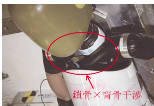
図1 4 試験後 Q3 ダミー (チャイルドシート E)
