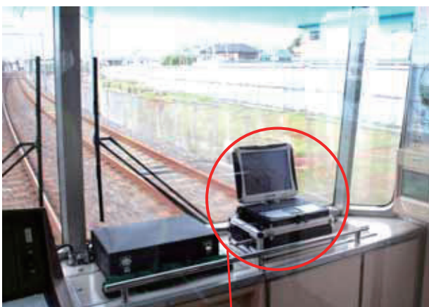
乗務員室に設置したプローブシステム
