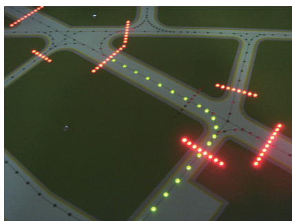
図4 灯火模擬パネルLED点灯状況
