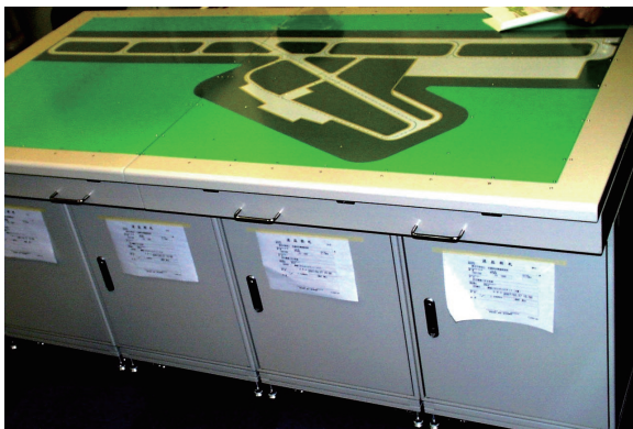
図3 灯火模擬パネル外観
