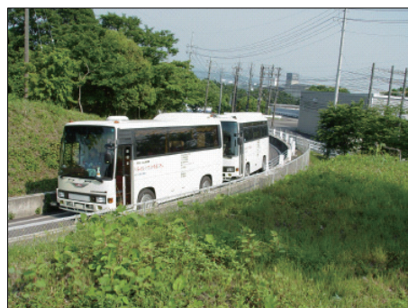
図 2 軌道上で連結走行する BMH 先行試作車両
