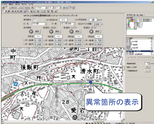
図8 地図表示による現場との照合
