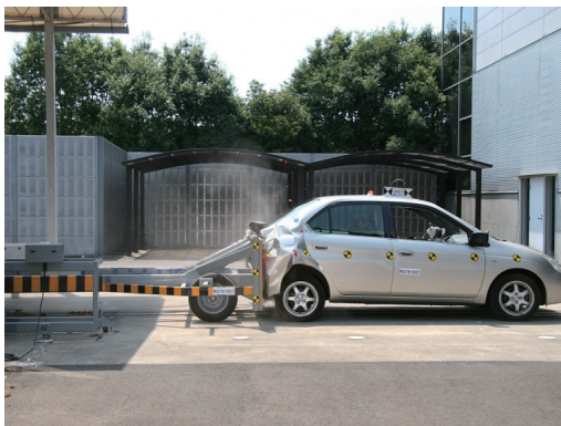
図2 衝突直後の状況(後面衝突)
