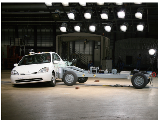
図4 衝突直後の状況(側面衝突)
