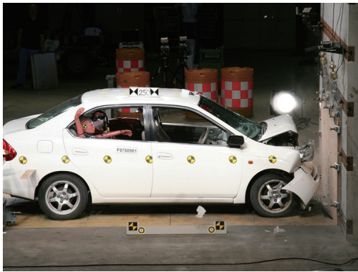
図1 衝突直後の状況(フルラップ前面衝突)
