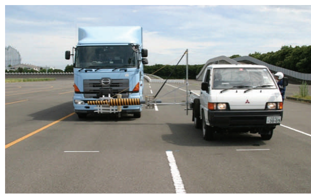
図5 試験風景 (移動障害物作動確認試験)
