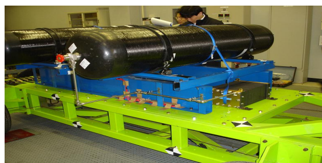
図1 ガス容器取付模擬装置の搭載状況
