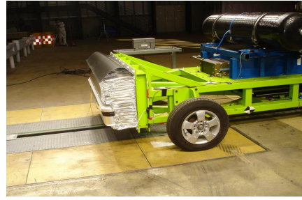
図2 衝突実験前後のハニカムの変形状況
