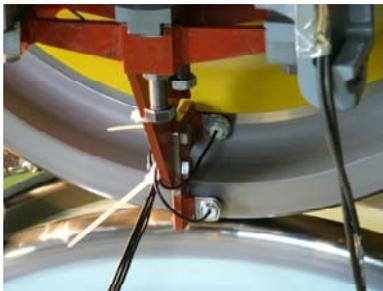
図5 横圧測定用センサの取付状況(台上試験)
