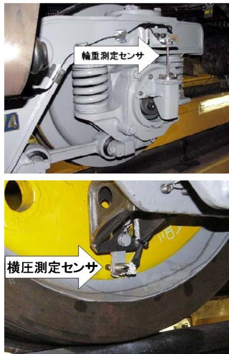
図7 量産仕様台車と輪重・横圧測定用センサ
