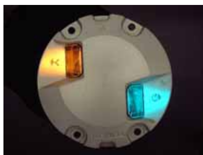
図1 供試 LED 灯器 (誘導路中心線灯)
