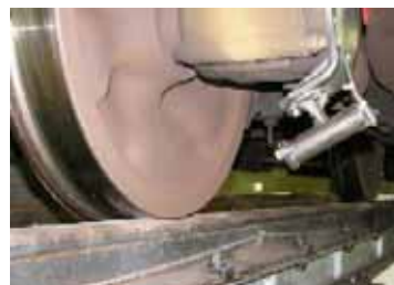
図2 車輪近傍騒音の測定状況
