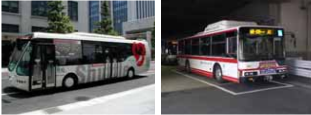
(ガスタービン発電車両) (ディーゼル発電車両) 図1 運行中のシリーズハイブリッド車両
