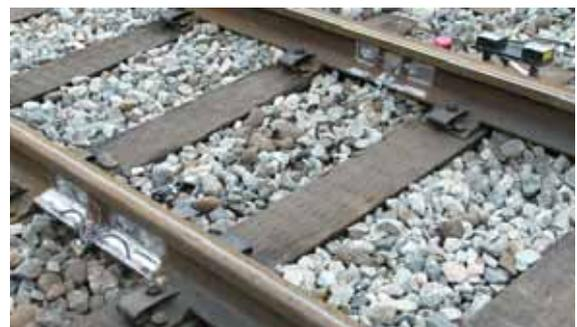
図6 脱線係数・アタック角地上測定
