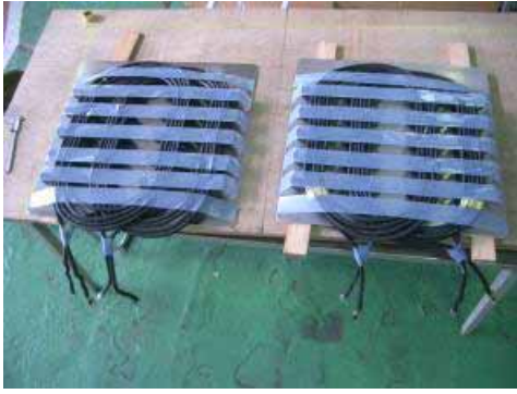
写真1 昭和飛行機型ピックアップ (送電・受電ピックアップ両者)
