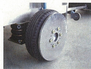
図2 タイヤに固定した吸音ホイールカバー
