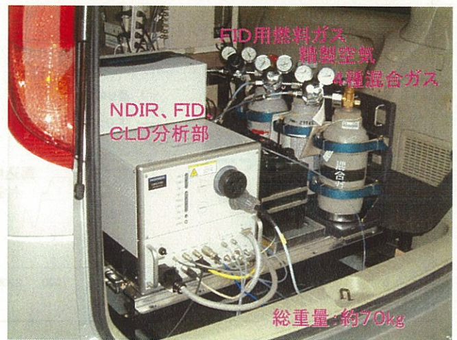
写真1 車載式排出ガス分析装置（プロトタイプ）の外観
