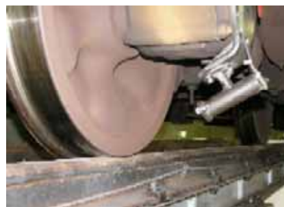
図2 センサの取り付け例(車輪近傍騒音用マイクロホン)
