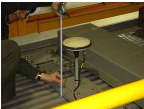
図7 アンテナ取付状態
