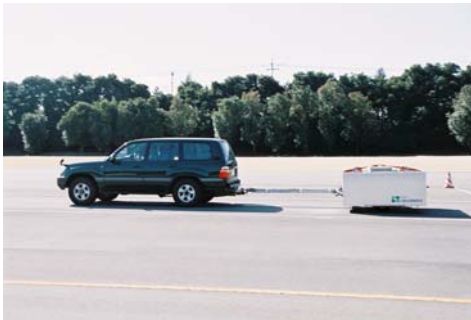
図3 テストコースでの測定の様子 (防音ケースを閉じて走行)
