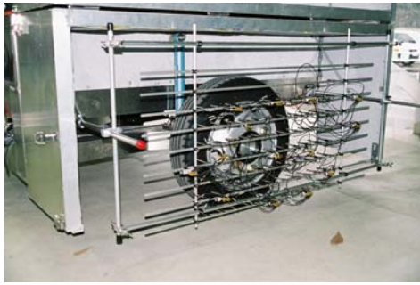
図2 タイヤ騒音測定用トレーラの写真 (防音ケースを開けた状態)
