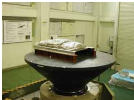
図10 砂を搭載した吸音板の振動試験の様子
