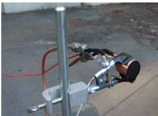
図 - 3 熱電対と熱流束計の固定状況
