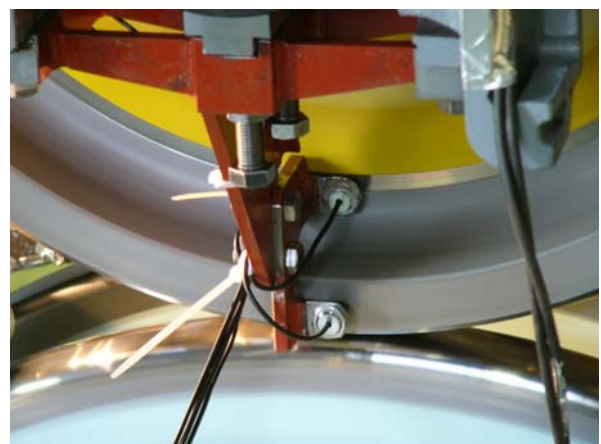
図5 横圧測定用非接触式変位計の設置状況 (台上試験)
