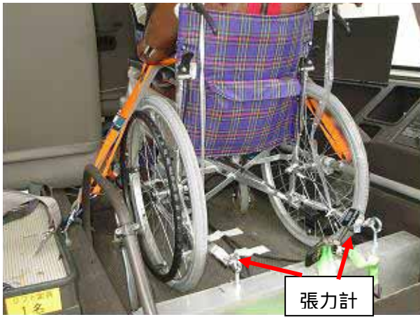
図3 車椅子 A 方式固定
