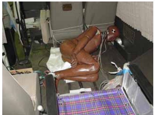
図5 ダミー落下状況
