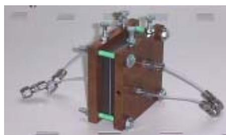
図1. 実験に使用した固体高分子形燃料電池
