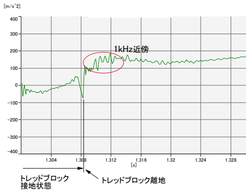
図 1 1 惰行走行時におけるトレッドブロックの振動加速度の変化 (図10のD 1 部分の詳細)
