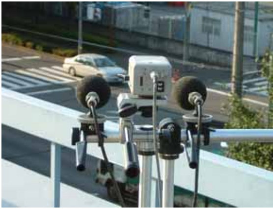
図2 CCDカメラとマイクロホンの設置状況
