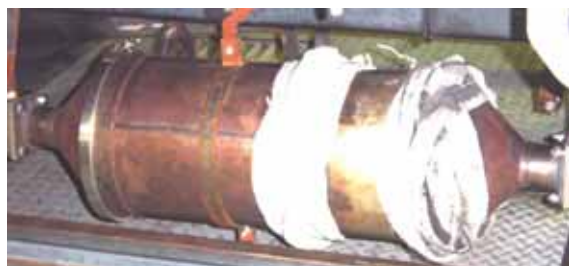
図2b 供試連続再生式DPFの外観
