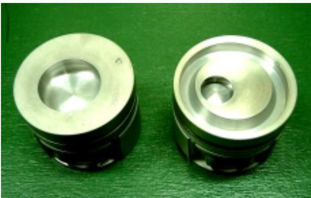
図3 実験に使用した標準ピストン(左)と局所リッチ燃焼用ピストン(右)
