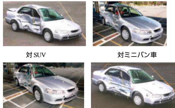
図 2 実験後の被衝突車の外観写真
