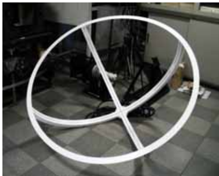
図2-2 有効視野範囲測定装置 LED取付腕
