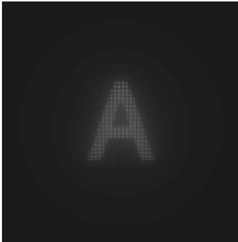
(a) 光学深さ3, 平均粒径3 μm 文字パターンA (文字点灯)
