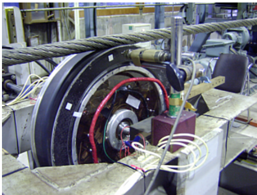
図3 荷重測定用索輪を用いた実験状況
