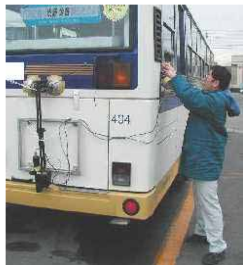
図2 バス車体後部への車速センサの取付
