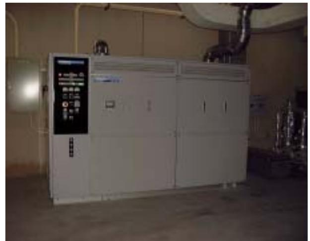
図5 低濃度分析時に用いる希釈空気生成装置外観
