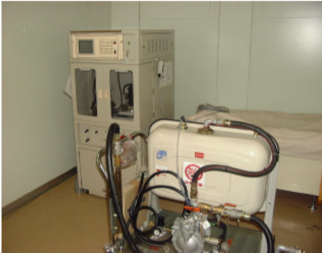
図5 キャニスタ容量限界測定装置及び燃料交換装置
