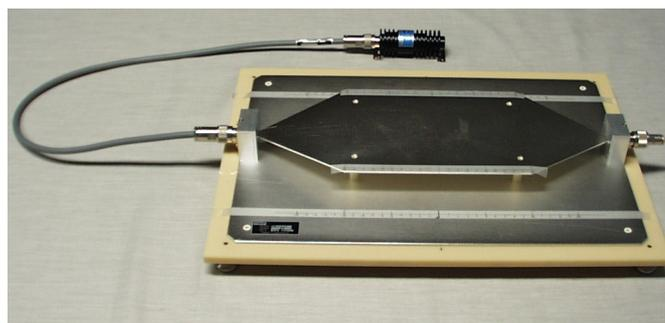
図1 表面電流発生装置の外観
