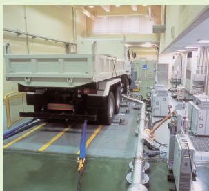
大型車用シャシダイナモメーター設備
