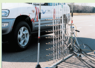
音響ホログラフィ法による タイヤ騒音の測定
