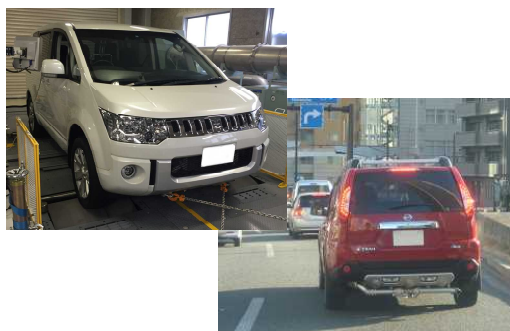
試験風景および路上走行試験におけるNOx排出量
