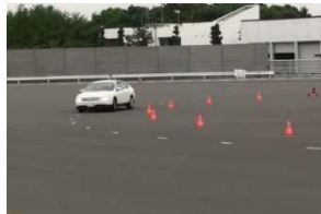
パワーステアリング失陥時の操舵力確認実験
