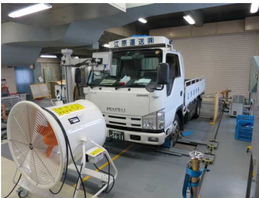
CNG 車の試験風景
