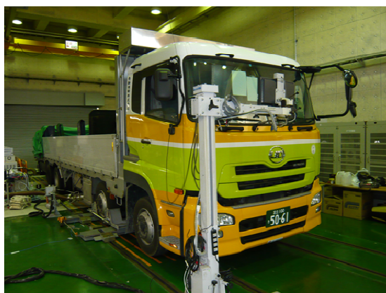
シャシダイナモメータ上での排出ガス試験の様子
