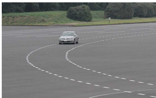
曲線路における LKAS の試験法検討
