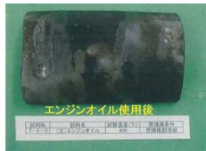
初期消火を想定した段階でのエンジンオイル焼損痕の再現状況
