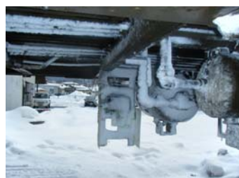
衛星測位による検知精度 評価のための別系統の列車 位置測定装置
