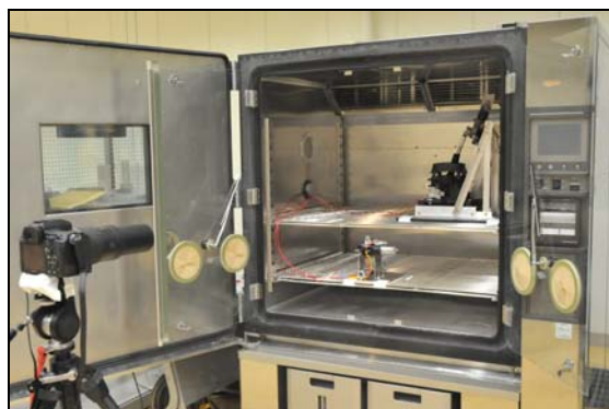
AT シフトレバーの高温高湿環境下での単体耐久試験の実施状況
