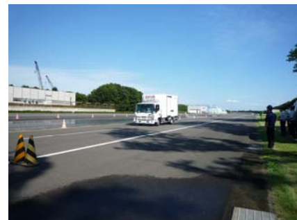
(ウエット路面でのブレーキ効き過ぎ調査) (ドライ路面でのブレーキ効き過ぎ調査) 制動カアシストの作動条件に関する検証実験の様子
