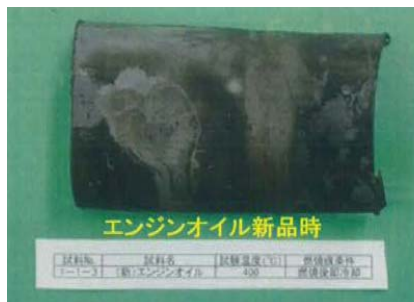
初期消火を想定した段階でのエンジンオイル焼損痕の再現状況
