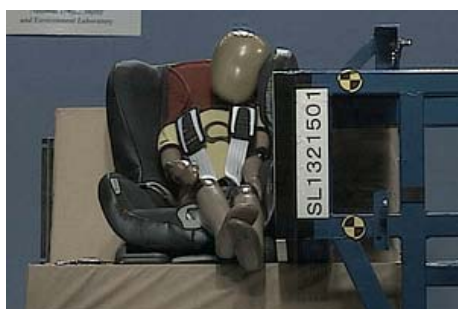
CRS側面衝突スレッド試験
