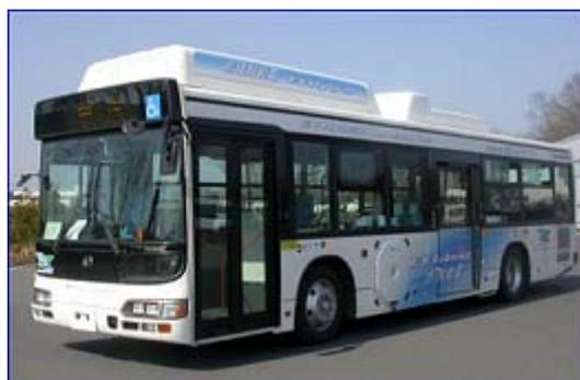
非接触給電システム搭載のプラグインハイブリッド自動車
