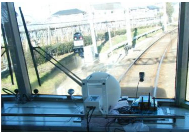
定在波測距レーダによる架線・信号機柱、列車速度検出試験
