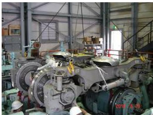
台車試験設備に置かれたD台車
