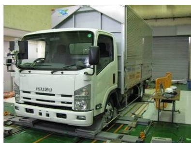
排出ガス経時変化の試験状況
