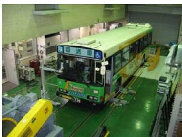
次世代燃料使用時の排出ガス試験実施状況
