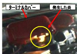
バッテリーの誤った取り付けによる発火メカニズムの調査
