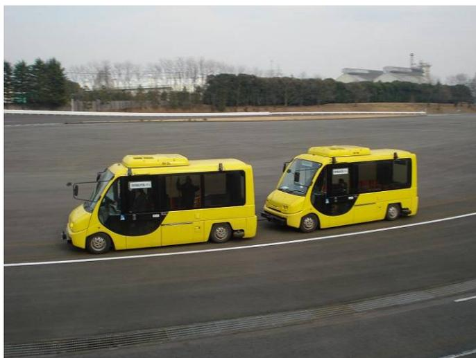
バイモーダル試作車両による非接触誘導案内・連結走行実験
