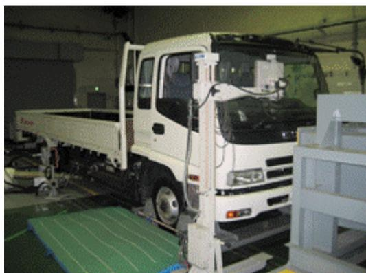
重量車の排出ガス試験の実施状況
