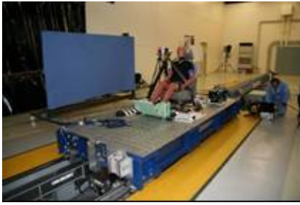
後面衝突スレッド実験の実施状況
