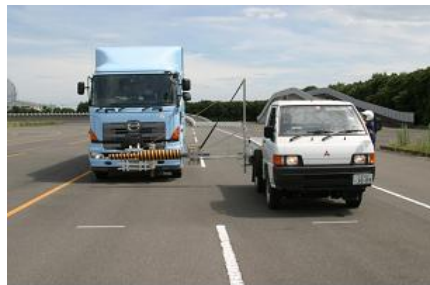
衝突被害軽減ブレーキ実験の実施状況
