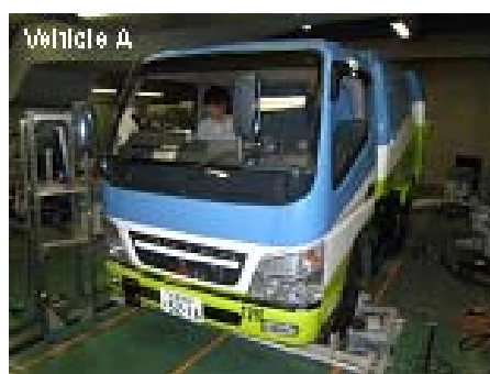
バイオディーゼル燃料実験状況とNO x ,PMの測定結果
