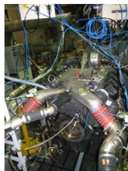
大型車用エンジンの排出PMの粒子数計測実験の概要
