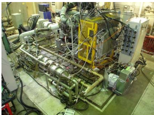
排出ガス試験の状況(エンジンベンチ室)
