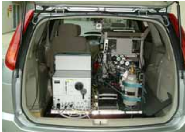
実使用条件下での燃費測定実験車両
