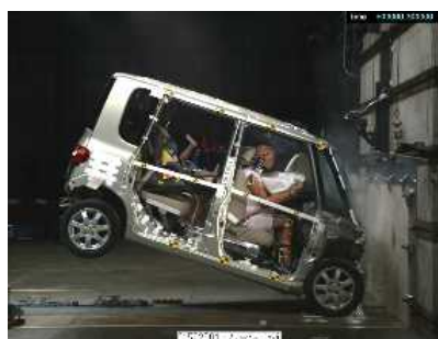
実車衝突実験状況 (衝突速度 60km/h)
