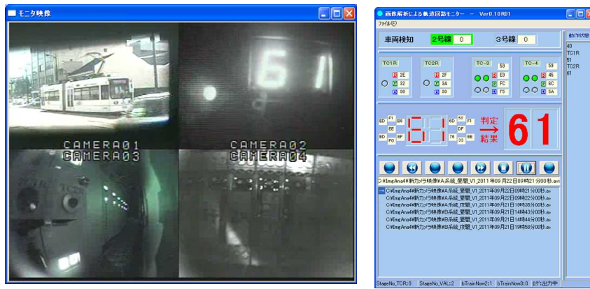
画像センサによる予防保全システムの例
