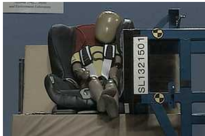
CRS 側面衝突スレッド試験
