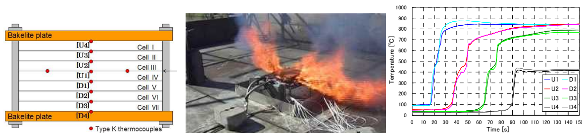
リチウムイオン電池の熱暴走実験
