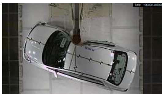
ポール側面衝突試験状況
