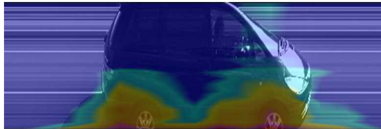
新たな可視化システムによる騒音源可視化結果の例
