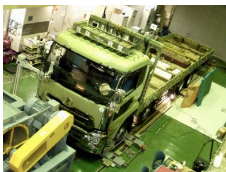
尿素SCR車試験状況
