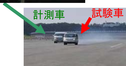
無線計測機を使ったエンジンの焼付試験
