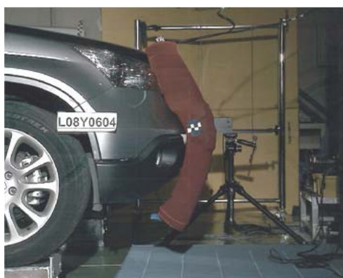
フレキシブル脚部インパクトの挙動
