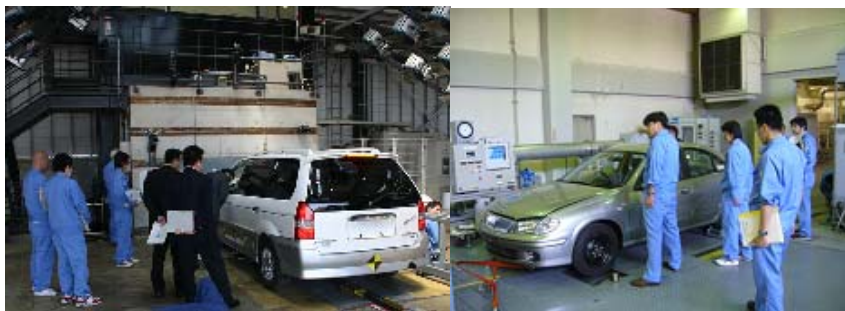
自動車審査試験実施能力認定のための研修の様子 (左:フルラップ衝突試験、右:排ガス試験)
