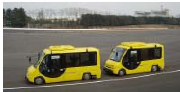
バイモーダル低床試験車両による実車走行実験
