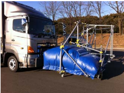
風船型模擬障害物を用いた衝突 被害軽減ブレーキの試験
