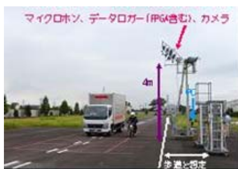
トラック、二輪車併走による実験状況
