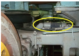
ダンパの故障模擬検証実験
