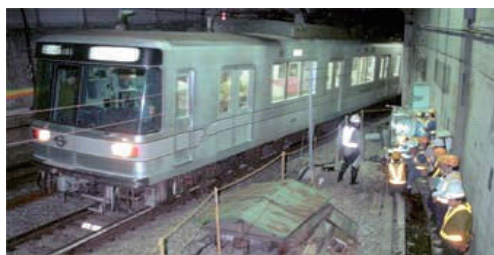
原因究明のための脱線係数測定
