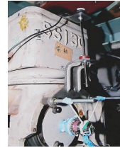
台車枠ひずみ による測定法
