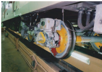
従来の輪重横圧測定法との 同時測定による比較検証
