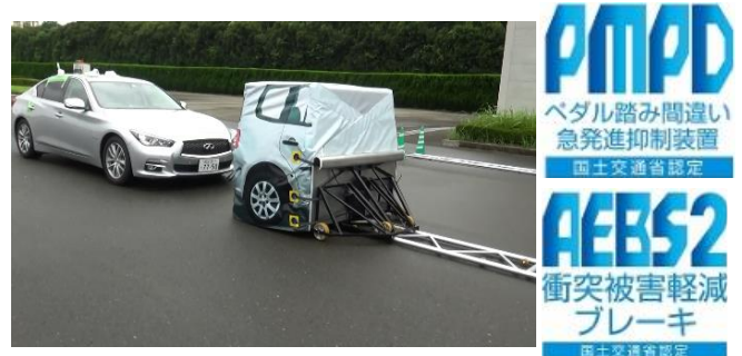
図2 衝突被害軽減ブレーキ性能評価試験の様子
